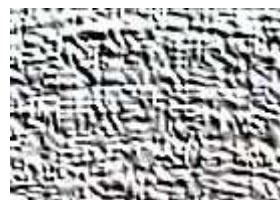
Elektron mikroskopunda STANDART YAĞLAYICILARDA AŞINMA PATERNİ
