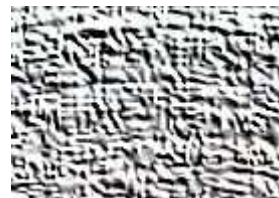
Elektron mikroskopunda STANDART YAĞLAYICILARDA AŞINMA PATERNİ
