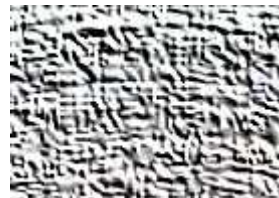
Elektron mikroskopunda STANDART YAĞLAYICILARDA AŞINMA PATERNİ
