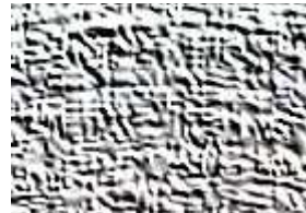
Elektron mikroskobunda STANDART YAĞLAYICILARDA AŞINMA PATERNİ
