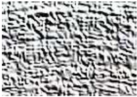
Elektron mikroskobunda STANDART YAĞLAYICILARDA AŞINMA PATERNİ
