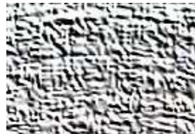
Elektron mikroskopunda STANDART YAĞLAYICILARDA AŞINMA PATERNİ
