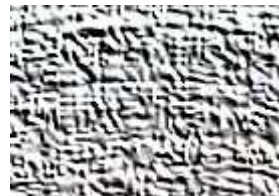
Elektron mikroskopunda STANDART YAĞLAYICILARDA AŞINMA PATERNİ
