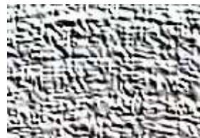
Elektron mikroskobunda STANDART YAĞLAYICILARDA AŞINMA PATERNİ
