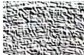
Elektron mikroskobunda STANDART YAĞLAYICILARDA AŞINMA PATERNİ
