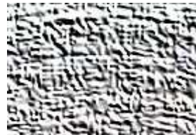
Elektron mikroskobunda STANDART YAĞLAYICILARDA AŞINMA PATERNİ
