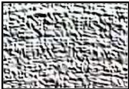
Elektron mikroskopunda STANDART YAĞLAYICILARDA AŞINMA PATERNİ
