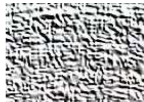
Elektron mikroskobunda STANDART YAĞLAYICILARDA AŞINMA PATERNİ
