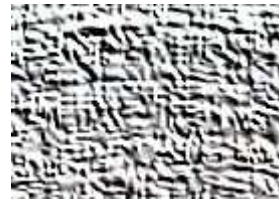
Elektron mikroskopunda STANDART YAĞLAYICILARDA AŞINMA PATERNİ
