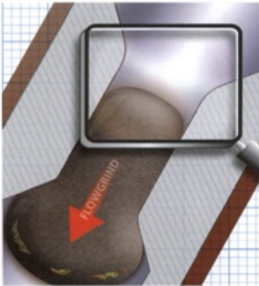
Kaldırılan parçacıklar Flowgrind'le ortadan kaldırılır. Sonuçta teknik olarak yüksek kaliteli ince perdahlanmış bir yüzey kalır
