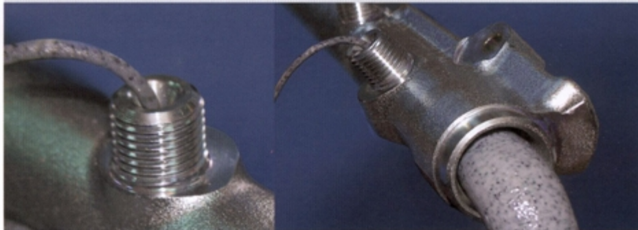
Flowgrind'in tipik uygulama alanı. Erişilmesi güç alanlarda çapak alma ve yüzey işleme.
